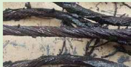
渗透能力极高，能完全通过油泥渗透进钢丝绳内部，减少内部钢丝脆化折断的情况
