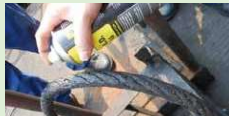
能溶化钢丝绳上的油泥及渗透进绳芯内部
